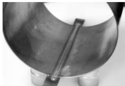
Рис. 5. Выполненный продольный сварной шов обечайки:
