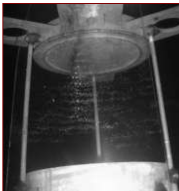
Рис. 8. Фото всплывающих пузырьков из областей кавитации Распределение пузырьков в проточном акустическом резонаторе
