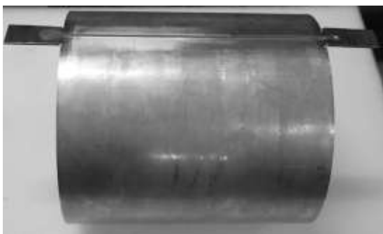
Рис. 5. Выполненный продольный сварной шов обечайки:
