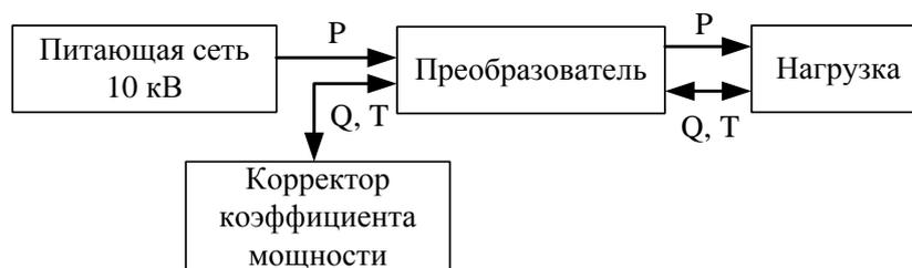
Рис. 2. Структурная схема потоков мощности при использовании ККМ
