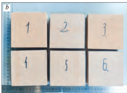
Рис. 3. Фотофиксация образцов после ускоренного климатического старения на 25 УГЭ: а – Gener VX 110; б – Sylomer SR 110
